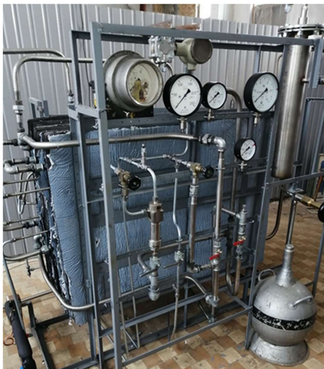
Фрагмент дослідно-промислової установки зрідження метану (Інститут газу НАН України).
