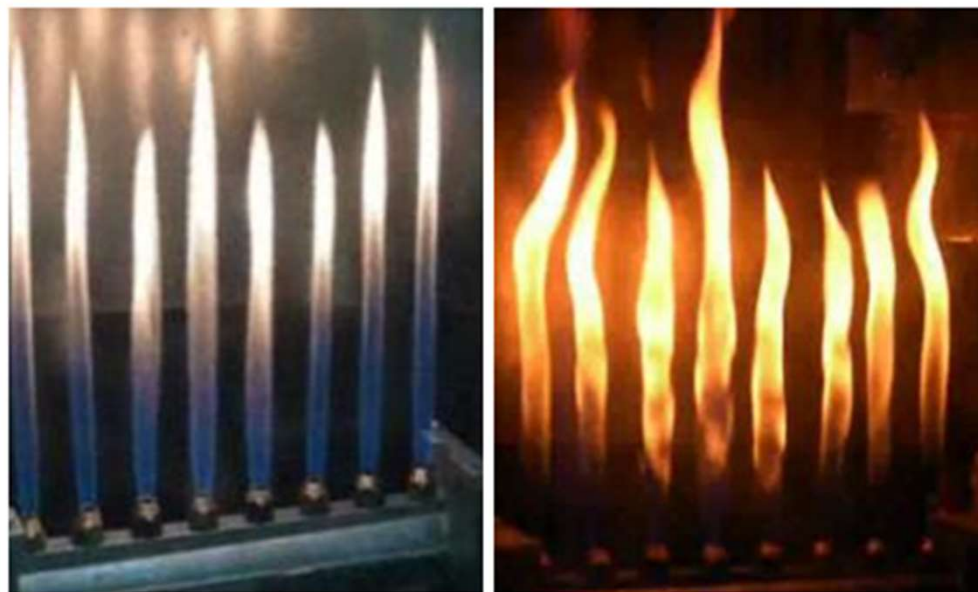
Вигляд факелу спалювання генераторного газу з соняшникової олії (а) та пічного палива (б) в пальнику побутового котла
