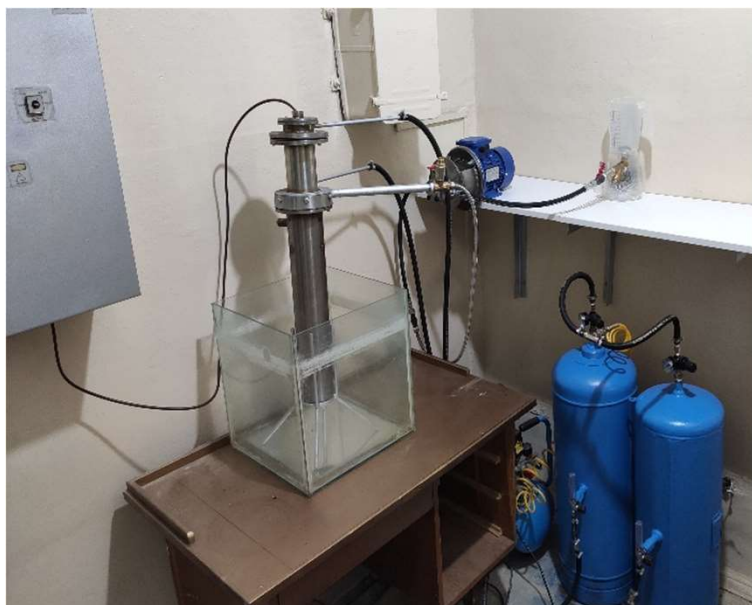
Установка газифікації рідких вуглецевмісних відходів
