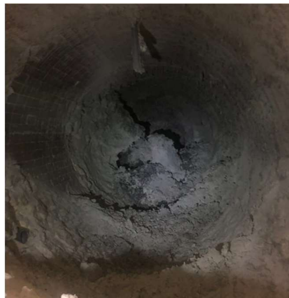
Вигляд амбразури пальника внаслідок заростання шлаком
