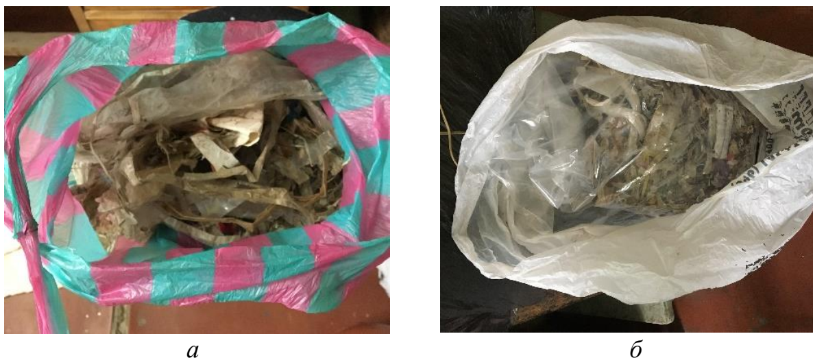
Рис. 4. Відібрані зразки: а – полімери з ТПВ, б – полімери з медичних відходів
