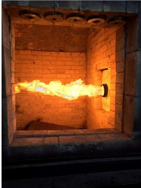
Рис. 1.5 - Камера згоряння інсинератору в режимі розігріву: модульно-блочний пальник EcoFlam, камера згоряння конструкції Інституту газу НАН України
