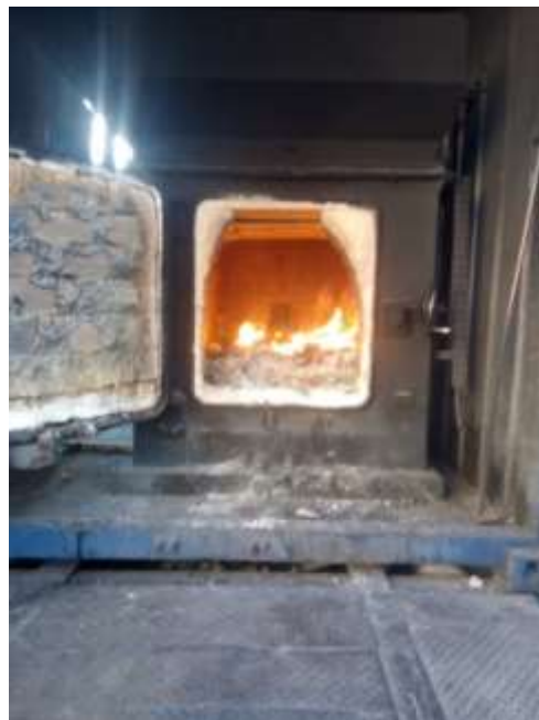
Рис. 1.6 - Закінчення циклу спалювання небезпечних відходів: пальники Riello, конструкція мобільної інсинераторної установки – Інституту газу НАН України
