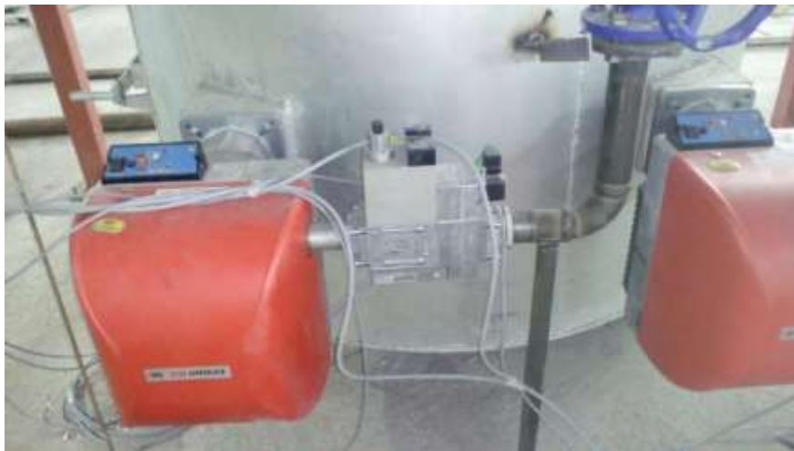
Рис. 1. 8 - Універсальна система опалення установки термодеструкції на рідкому і газовому паливі. Пальники SIB Unigas, конструювання технологічного обладнання для термодеструкції відходів – за участю Інституту газу НАН України
