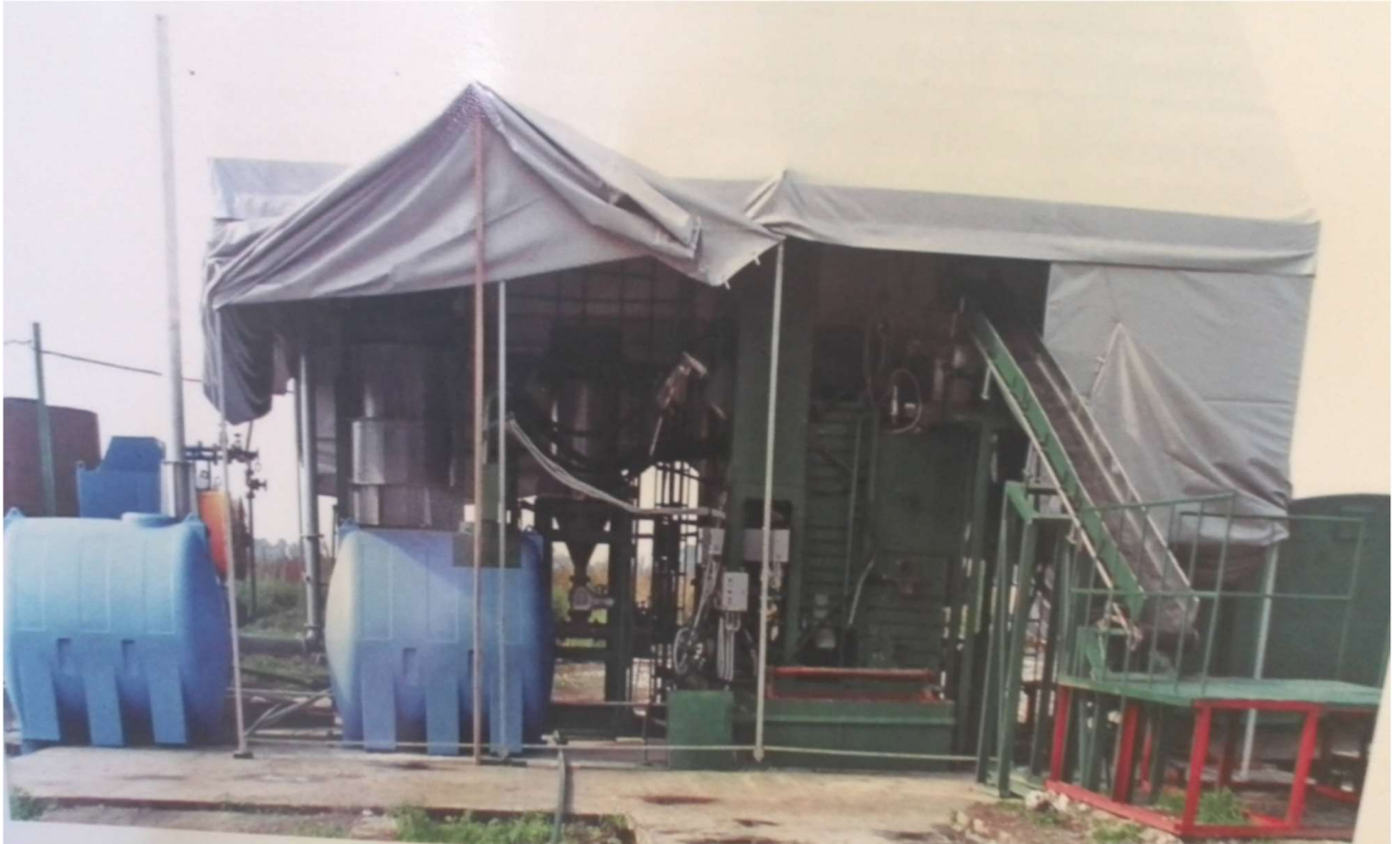
Рисунок 9. Установа для знешкодження заборонених та непридатних до використання ХЗЗР та СО 2 -вмісних оливо в розплавах солей лужних металів, продуктивністю до 100 кг/годину.
